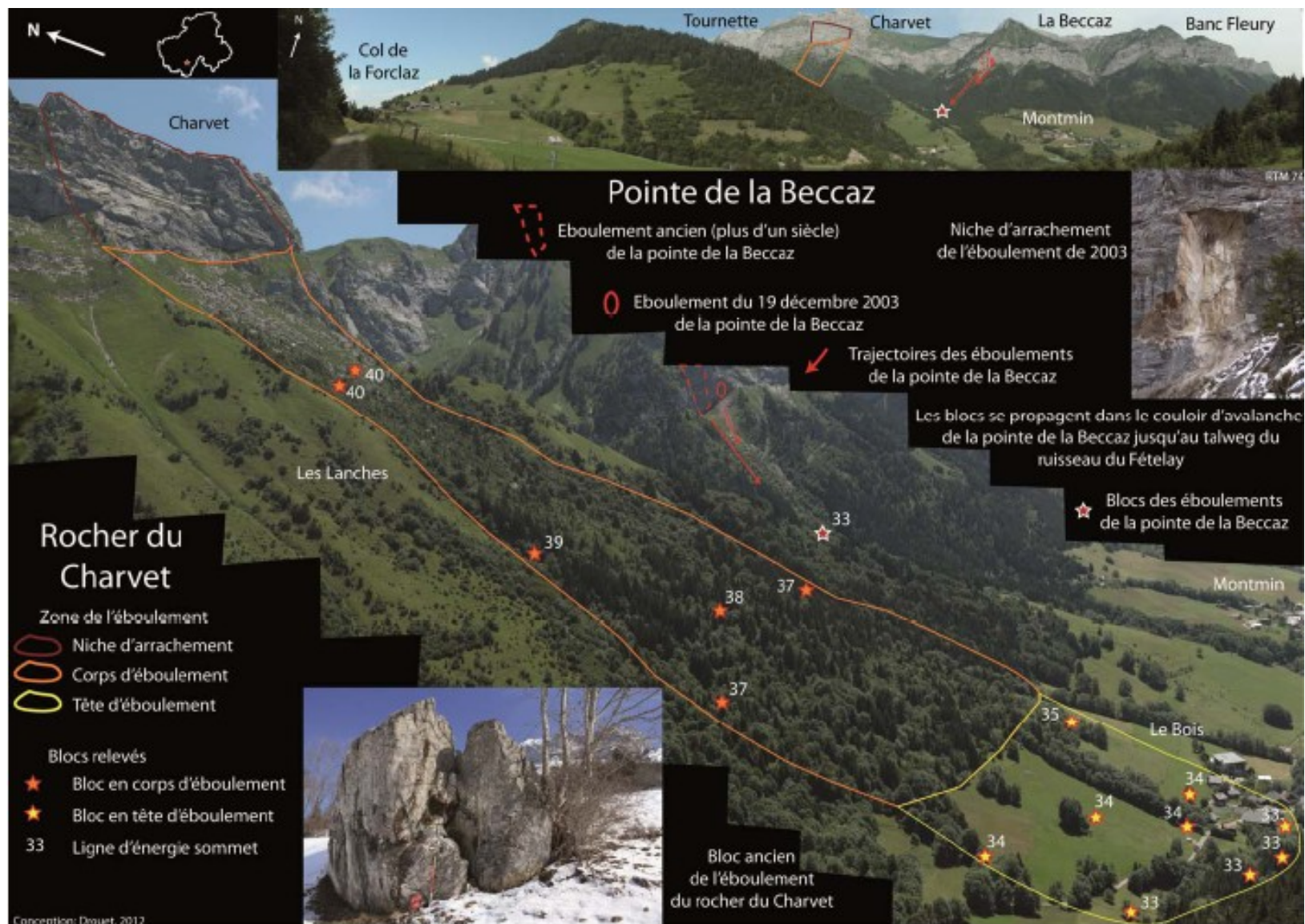
Fig 4 : Extrait de l'Expertise de terrain et modélisations trajectographiques : étude de propagation des aléas gravitaires rocheux via la théorie des lignes d'énergie – auteur Florent Drouet – RTM 74
