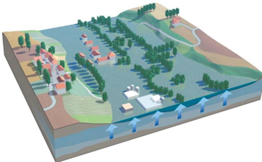
**Fig. 8 :** Schéma de principe d'une inondation par remontée de nappe [Source : [www.risquesmajeurs.fr](http://www.risquesmajeurs.fr) ]
