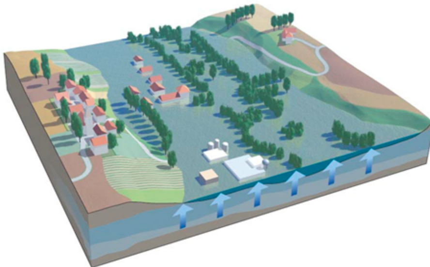
Fig. 8 : Schéma de principe d'une inondation par remontée de nappe [Source : www.risquesmajeurs.fr ]
