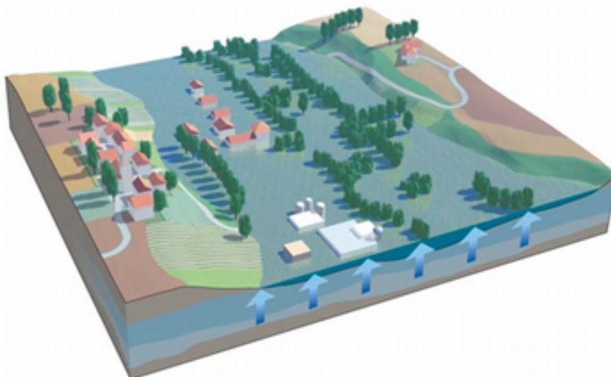
**Fig. 7** : Schéma de principe d'une inondation par remontée de nappe [Source : [www.risquesmajeurs.fr](http://www.risquesmajeurs.fr) ]
