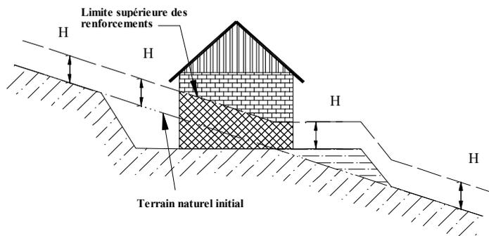
**En cas de terrassement en remblais**, la hauteur à renforcer sera mesurée depuis le sommet des remblais. Toute disposition architecturale particulière ne s'inscrivant pas dans ce schéma de principe, devra être traitée dans le sens de la plus grande sécurité.
