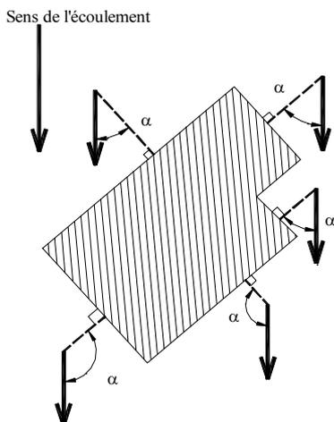
Le mode de mesure de l'angle  $\alpha$  est schématisé ci-après.
