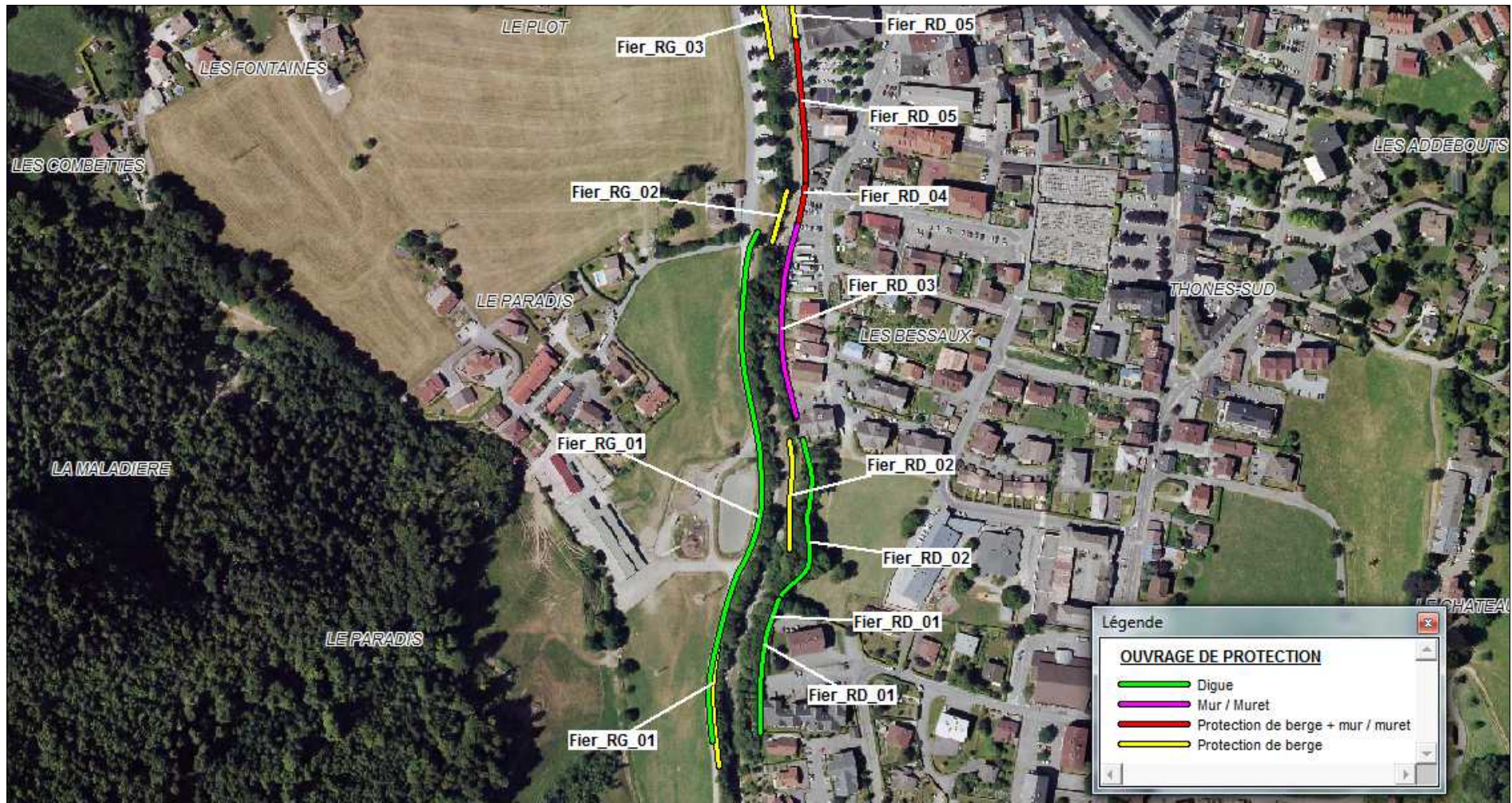
Fig. 22 : Localisation des ouvrages de protection hydrauliques sur le Fier (partie amont) [Source : IMS RV ]
