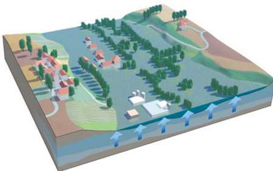
Fig. 13 : Schéma de principe d'une inondation par remontée de nappe [Source : www.risquesmajeurs.fr ]
