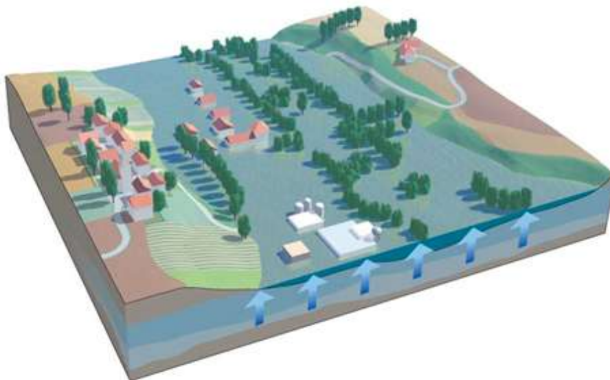
Fig. 10 : Schéma de principe d'une inondation par remontée de nappe [Source : www.risquesmajeurs.fr ]
