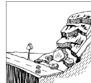
Figure 14 - Schéma montrant un talus avec un pendage aval sur la route
