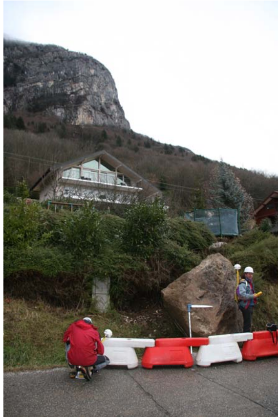
Photo 1 : Bloc de 6,25\text{m}^3 ayant eu la plus longue distance de propagation lors de l'événement du 20 janvier 2009 (photo Cemagref 2009).
