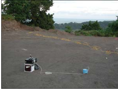
Figure 2 - Dispositif H/V (au premier plan à droite un sismomètre tridimensionnel 5s et à gauche la station d'acquisition)
