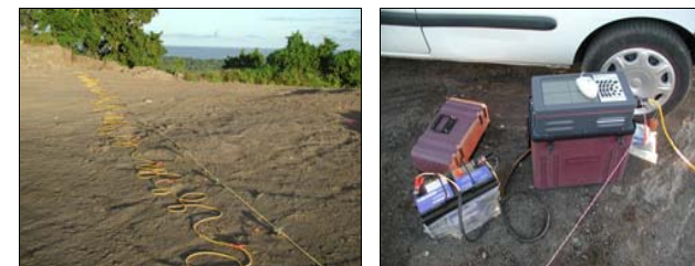
Figure 1 - Dispositif SASW (à gauche : flûte de géophones, à droite : station d'acquisition)
