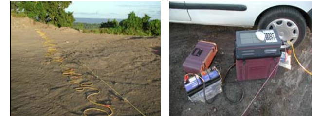
Figure 1 - Dispositif SASW (à gauche : flûte de géophones, à droite : station d'acquisition)
